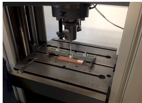
Die Prüfmaschine der HSLU mit 2,5 mm / min
